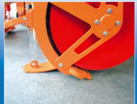
Verschleißfeste, geschraubte Stahlschürfleiste, einstellbare Gleitschuhe und Randabweiser
