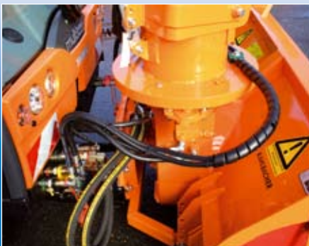
Anbau an fahrzeugseitiges Hubwerk Der Antrieb erfolgt Hydraulisch.
