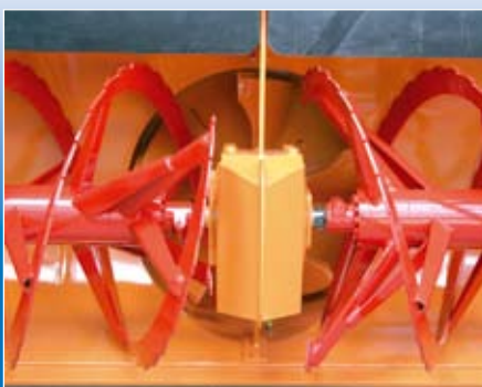
Frässhleudervorbau mit Frässhnecken und dahinterliegendem Schleuderrad mit großen Öffnungsquerschnitten
